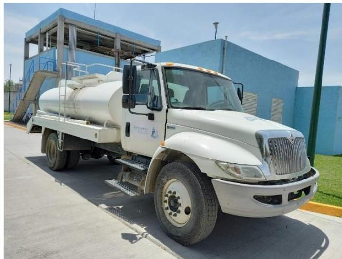
*Ilustración 8 Pipa para Transporte de Lodos*
