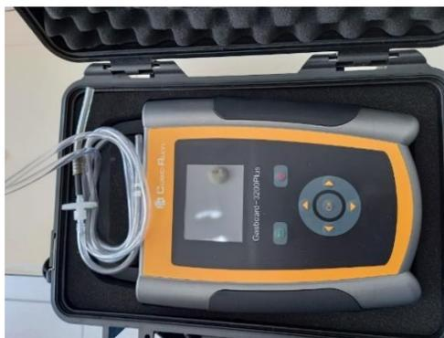
*Ilustración 11 Analizador de Gas*
